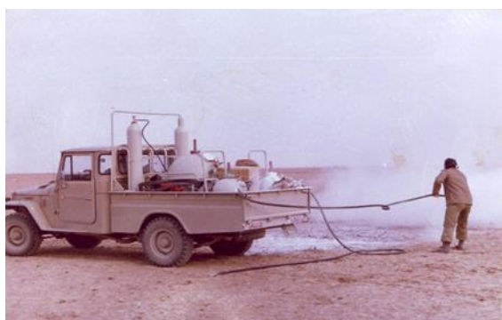
شکل-۲. انجام عملیات خنثی‌سازی محیط آلوده در یک حمله شیمیایی با استفاده از خودروی درخش
