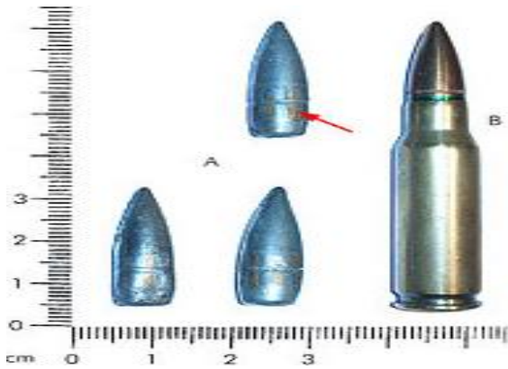
شکل-۱. نمونه گلوله مورد استفاده در تفنگ ژ ۳، با یک فشنگ شلیک نشده آن
